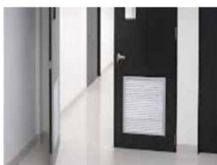
Obr. 4 Príklad použitia dverí so štrbinou – splnenie požiadaviek na minimálne vetranie QLMV (podľa EN 378-1)
